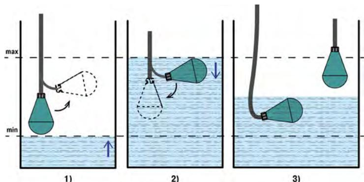
Рисунок 4.2 – Принцип действия
